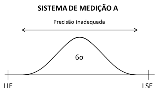
Figura 1 Representação de um sistema de medição com precisão inadequada.
