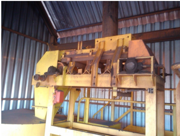
Figura 9 - Correia do amostrador, chute e divisor rotativo de amostra.
