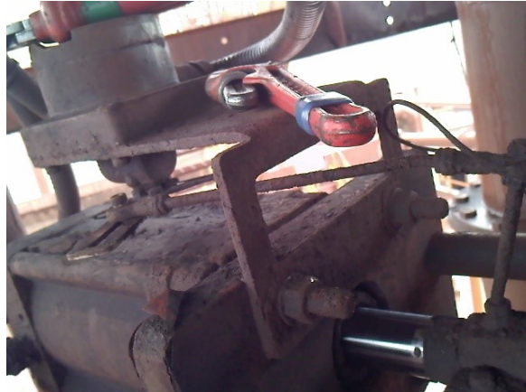
Figura 4 - Detalhe do sistema de transmissão de movimento para o sensor de posição
