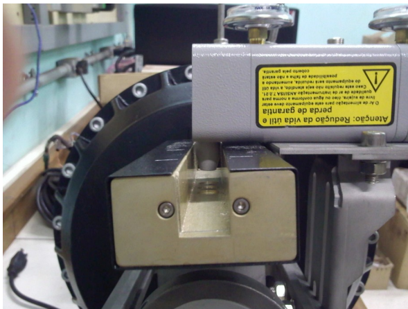
Figura 6 - Sensor de posição sem contato, linear e sem transferência de movimento linear para rotativo como acontecia na outra válvula
