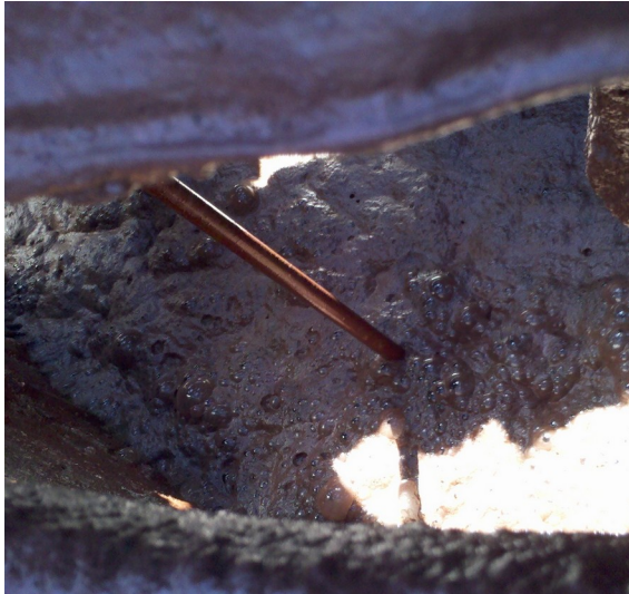
Figura 11 - Haste de medição inserida na caixa de distribuição. Nota-se a formação de espuma.
